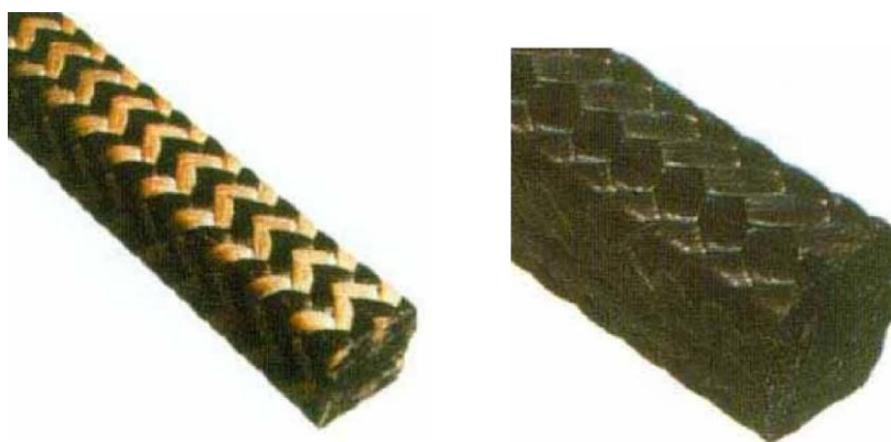
Рис. 10. Примеры комбинированных плетеных волокон
