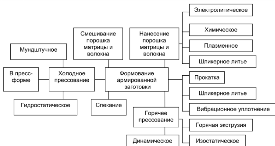
Рис. 1.Схема технологического процесса получения МВКМ методами порошковой металлургии
