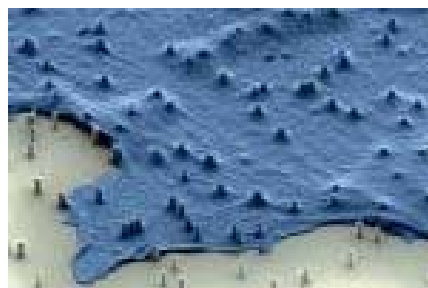
Рис. 146. Массив вертикальных нанотрубок, «протыкающий» клетку, используется для избирательной и точной доставки в нее необходимых веществ
