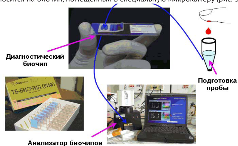
Рис. 59. Схема анализа с применением биочипа
