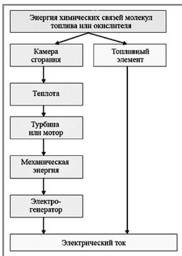
Рис. 2. Производство электрического тока за счет энергии химических реакций
